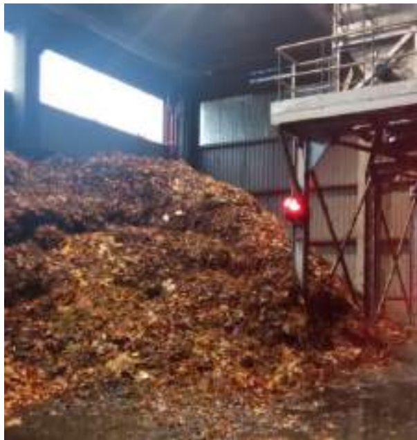
Nave de acopio de digesto de la planta de biometanización de Las Dehesas
