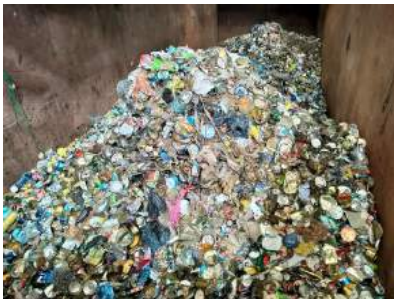
Material férrico recuperado en el pretratamiento de la planta de biometanización de Las Dehesas
